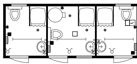
3 WC's, 3 Waschbecken, 3 Duschkabinen, 1 Boiler 300 l, 3 E-Heizungen, 3 Lampen
