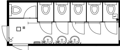
6 WC's, 3 Waschbecken, 3 Boiler 5 l, 1 E-Heizung, 2 Lampen
