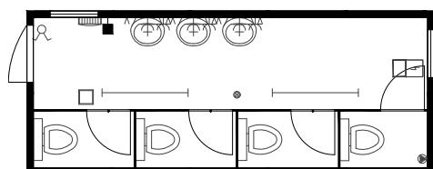
4 WC's, 3 Waschbecken, 3 Boiler 5 l, 1 E-Heizung, 2 Lampen
