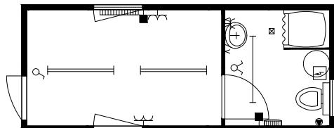
1 WC, 1 Waschbecken, 1 Duschkabine, 1 Boiler 80 l, 2 E-Heizungen, 2 Lampen
