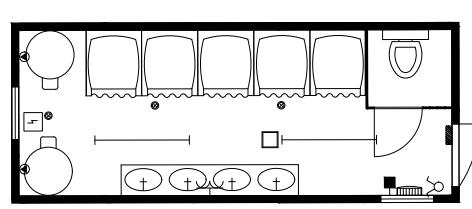
1 WC, 4 Waschbecken, 5 Duschkabinen, 2 Boiler 300 l, 1 E-Heizungen, 2 Lampen
