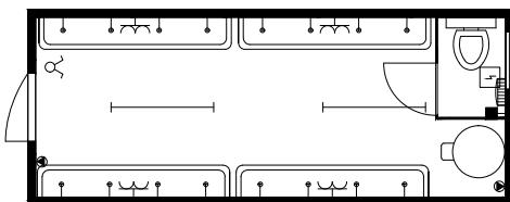
1 WC, 4 Inox-Waschrinnen mit 16 Wasserhähne, 1 Boiler 300 l, 1 E-Heizung, 2 Lampen
