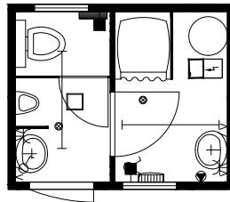
1 WC, 2 Waschbecken, 1 Urinal, 1 Duschkabine, 1 Boiler 80 l, 2 E-Heizungen, 2 Lampen
