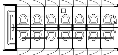
14 WC's, 1 Inox-Waschrinne mit 3 Wasserhähnen, 6 Lampen, ohne Heizung bei Minus-Temperaturen nicht geeignet
